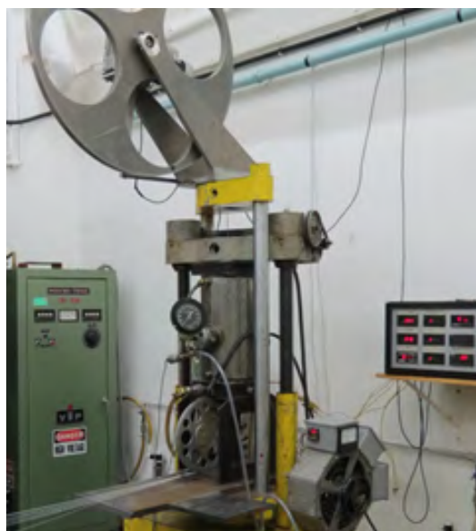
8. ábra. A szálköteg áthúzása a kompozituzal gyártási folyamatában
