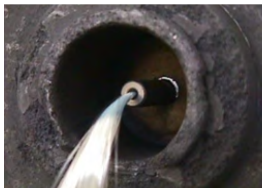
5. ábra. A bemeneti kapuba befűzött, áthúzásra előkészített CeraFib 99 szálköteg
