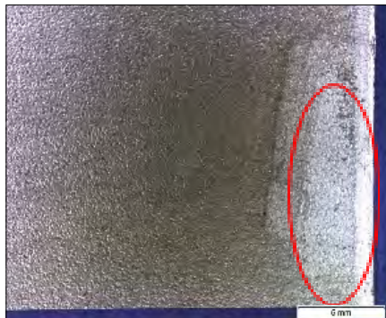
11. ábra. Karcolt (balra) és drótképezett 1.4362 acél próbatestek felülete két hónap után
