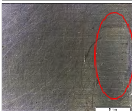
9. ábra. Karcolt (felső) és drótkéfézett 1.4462 acél próbatestek felülete két hónap után
