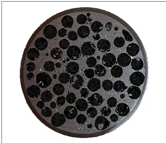
3. ábra. Egy lépésben előállított, szintaktikus fémhabbal kitöltött vékony falú acélcső
