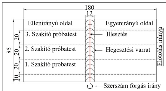
2. ábra. Hegesztési próbatestek kivágása és számozása (méretek mm-ben)
