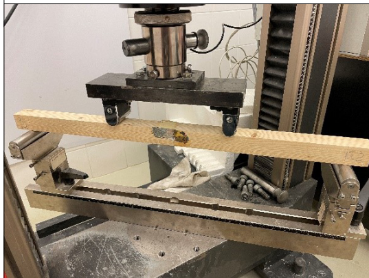
26. ábra. A felső övben gyengített, műgyantával erősített próbatestek hajlítási teherbírásának vizsgálata
