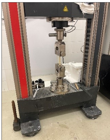
3. ábra. A műgyanta húzási teherbírásának mérése
