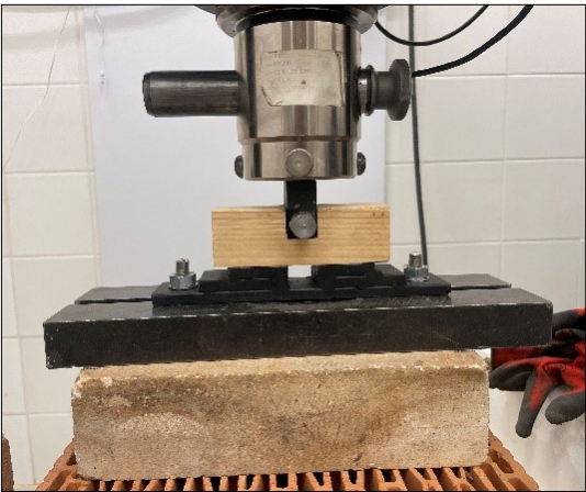
19. ábra. A gyengítéssel ellátott próbatest nyírási teherbírásának vizsgálata
