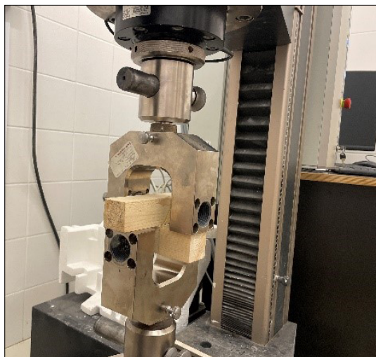
15. ábra. Műgyanta és szálirányú fa tapadásvizsgálatának mérése
