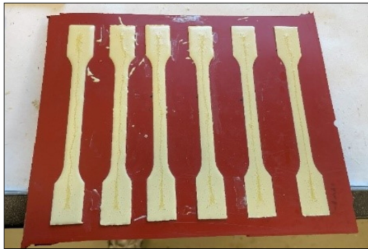
2. ábra. A műgyanta húzószilárdságának meghatározásánál alkalmazott próbatestek
