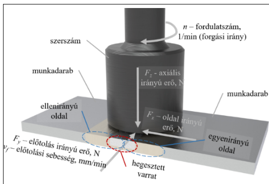
1. ábra. A kavará dörzshegesztés sematikus ábrája [8]
