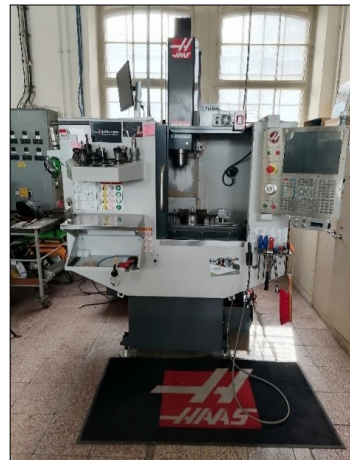
3. ábra. Haas Mini Mill Edu megmunkálóközpont
