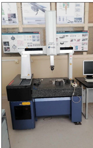
4. ábra. Mitutoyo Crysta Plus 574 mérőgép
