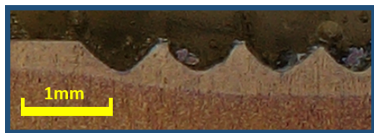
3. ábra. 150 Ws/mm-es fajlagos hőbevitellel végzett felületi hőkezelés hatása a 22. mintánál
