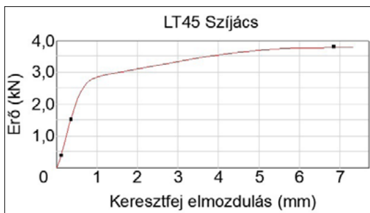
11. ábra. Erő-elmozdulás diagram – LT45 szíjács
