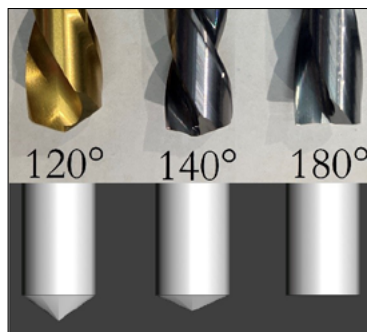
6. ábra. Előfúrók lehetséges csúcsszögei és az általuk kialakított lehetséges furatképek
