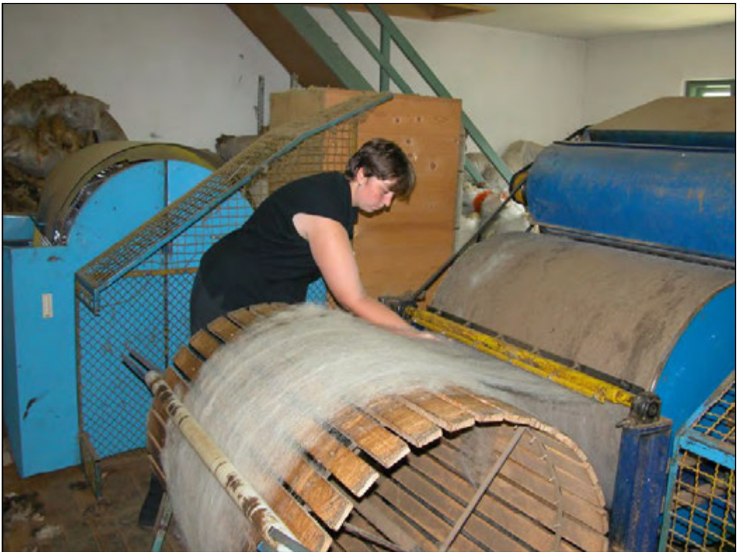
6. kép. Gyapjufésülő gép a Mózes Gyapjufeldolgozó Manufaktúra csíkkarcfalvi műhelyében (Kerekes Ibo-lya felvétele)
