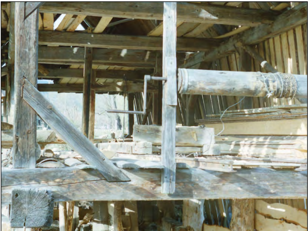
9. kép. Emberi erővel működtetett csörlős előtolás (húzás)
