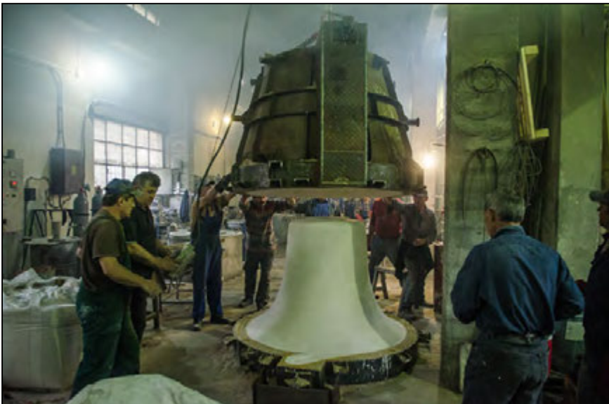
3. kép. A formaszekrény összeszerelése öntés előtt
