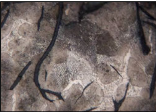
32. kép. A vizsgált minta szövetszerkezete erősebb maratás után (grafit, ledeburit, perlit, szteadit)
