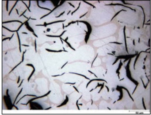
31. kép. A vizsgált minta szövetszerkezete maratás után (ledeburitos szövetszerkezet)
