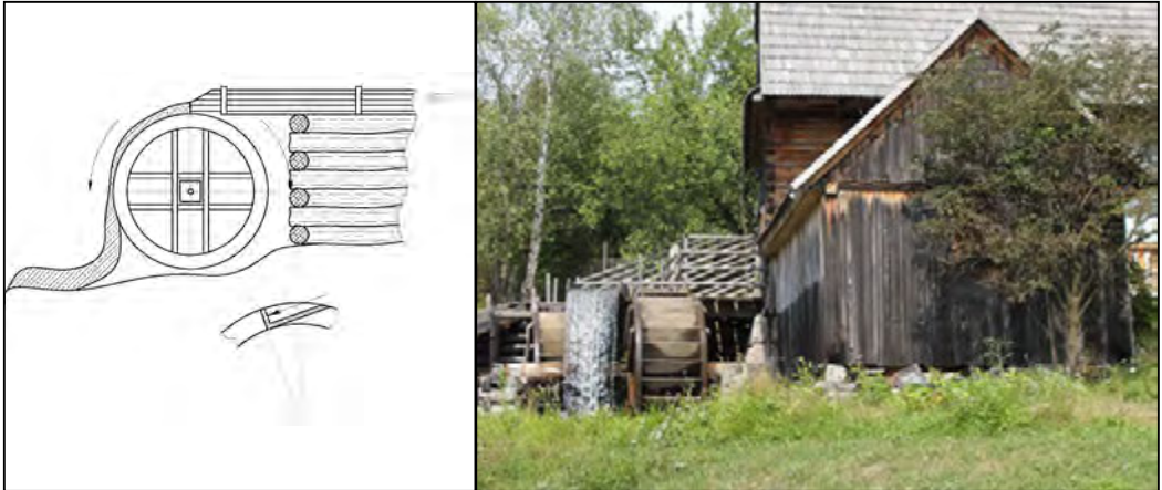
4. ábra. Felülcsapós vízikerék
