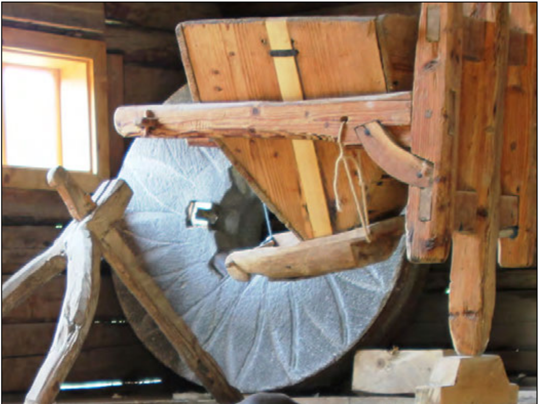
8. kép. Újravágott malomkő őrlő felülete
