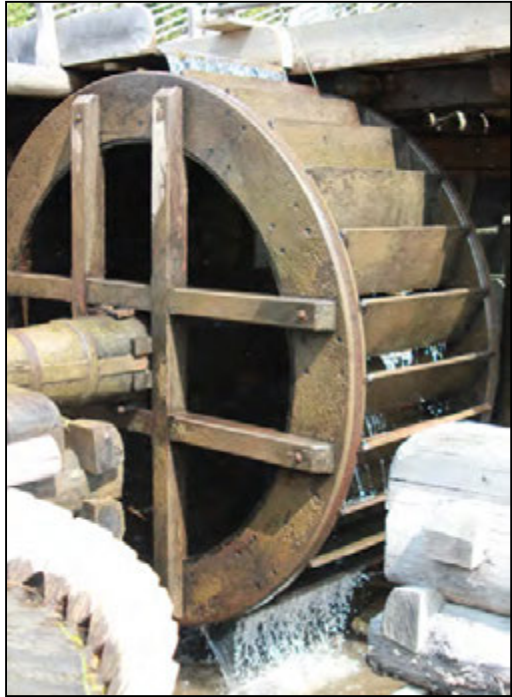
6. kép. A felülcsapós vízikerék felépítése
