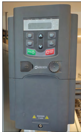
4. ábra. Morgensen MSI200A-004G/5R5P-4-típusú frekvenciaváltó
