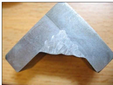
3. ábra. Hegesztett varrat polírozva és maratva
