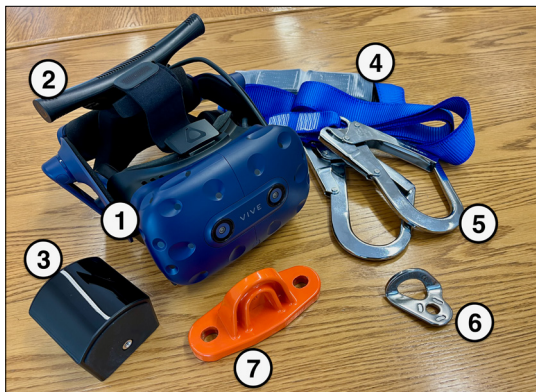
1. ábra. A kutatás során felhasznált eszközök: (1) HTC Vive PRO VR-szemüveg, (2) VIVE Wireless Adapter, (3) SteamVR Base Station 2.0, (4) Portwest FP51 Y-heveder, (5) Portwest FP35-horogkarabiner, (6) CADO AT 150 fix kikötési pont, (7) CADO AT 150 fix kikötési pont
