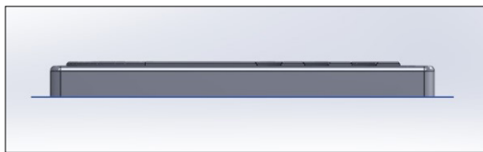
6. ábra. Osztósík oldalnézetből (alkatrész alján, vonallal jelölve)
