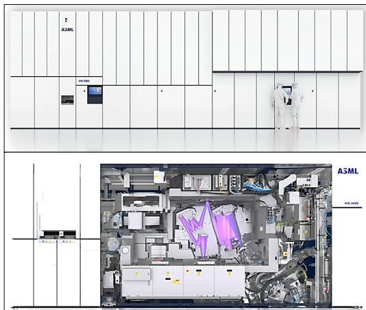
6. ábra. Az ASML EXE:5000 nagy numerikus apertúrájú, extrém UV-litográfiai, tekintélyes méretű berendezése (forrás: ASML) az UV-sugármenetek szemléltetésével [6]
