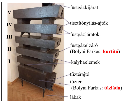
1. ábra. A tanulmányozott Bolyai-kályha felépítése
