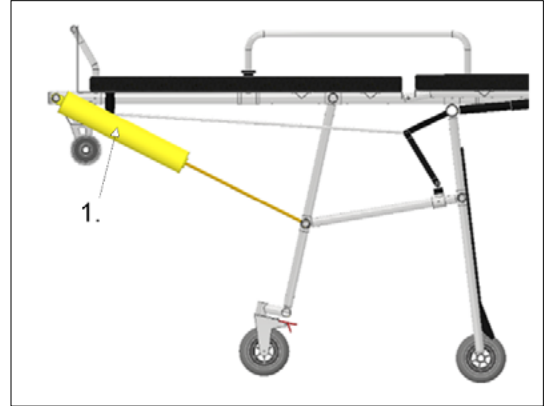
8. ábra. III. ajánlott megoldás nyitott állapotban: 1. munkahenger
