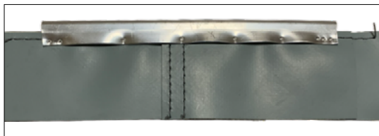
1. ábra. Szövetre roppantott profilmintadarab
