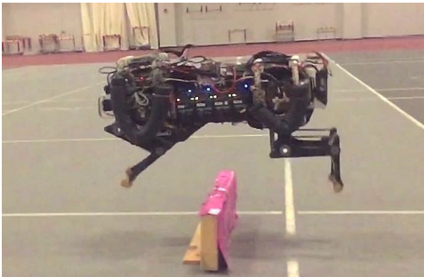
6. ábra. Az MIT Cheetah 2 robot, mely gátat tud ugrani 2,4 m/s sebességnél.
