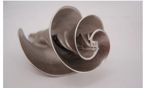
4. ábra. A kála virágjának alakját utázó keverő szerszám energiaszükséglete töredéke a hagyományos szerszámhoz képest.
